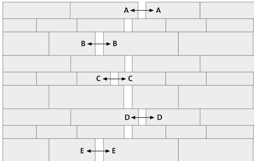
Eine Steinlage besteht aus 3 Blöcken von je 7 unterschiedlichen Formaten.
