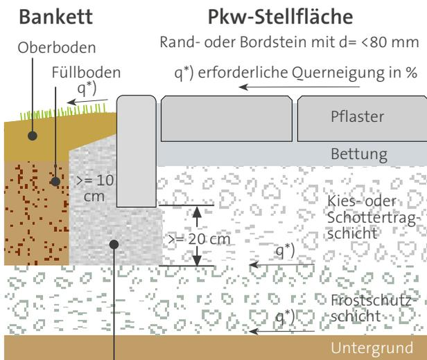
Fundament und Rückenstütze aus Beton mit einer Druckfestigkeit  $\geq 12$  MPa
