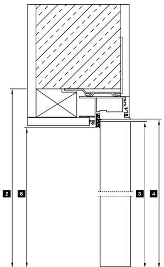
Horizontalschnitt mit stumpfem Türblatt
