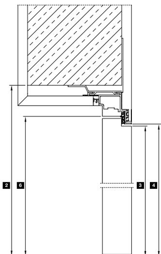
Horizontalschnitt mit reverse-öffnendem Türblatt
