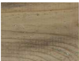
Stockflecken und leichter Schimmelbefall
